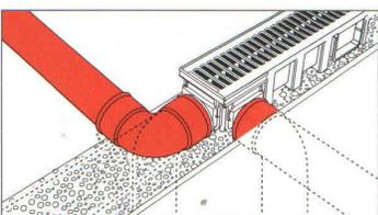
Povezati prvi deo kanala sa odvodom za kišnicu.
