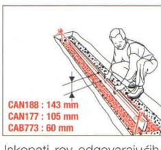
Iskopati rov odgovarajućih dimenzija (10 cm oko kanala). Napravite ležište od betona prema potrebnoj dubini.
