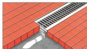
Pouniti betonom i uraditi završni sloj (popločati npr.) koji bi trebalo da bude 3 mm iznad rešetke.
