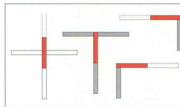
Podloga od betona i betoniranje se moraju izvesti prema gore prikazanim skicama. U slučaju značajnih nagiba ili opterećenja većih od 1,5 t betonirati do najniže tačke ivice kanala.
