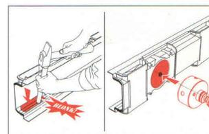
Za kanal CAB773 izbite bočni deo sa unutrašnje strane i izbušite vertikalni priključak.
