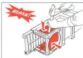
Izbite čekićem oslabljeni bočni deo i namestite željeni priključak.
