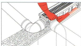
Ispuniti betonom bočne stranice kao na slici.
