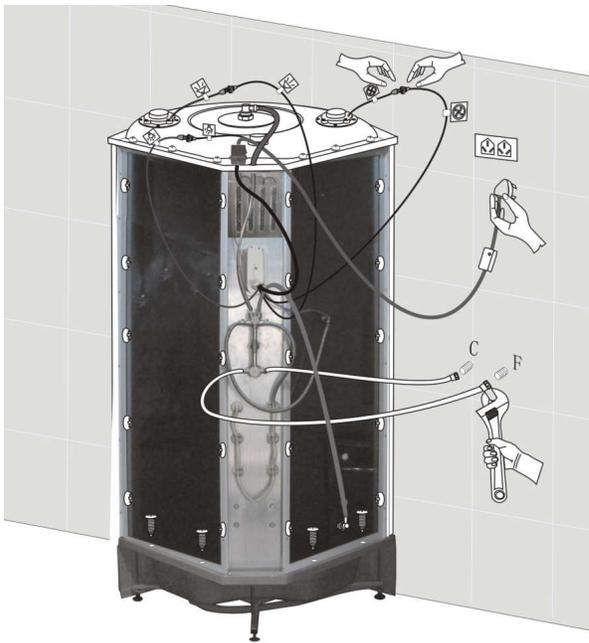
Svi električni uređaji koji se koriste u ovom proizvodu imaju zaštitu od curenja struje i povezani su sa uzemljenjem. Za njihovu instalaciju moraju biti odgovorni profesionalni radnici.
