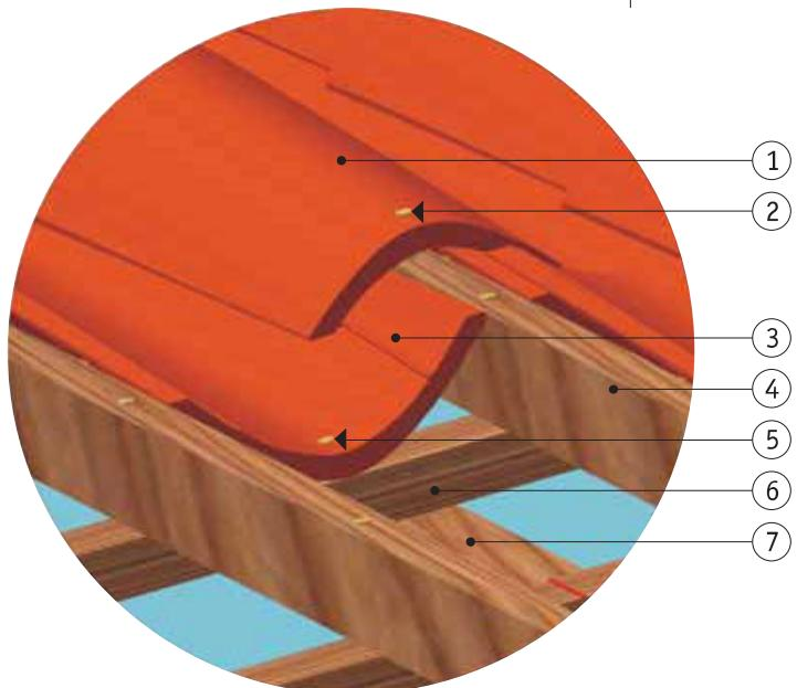
U slučajevima gdje je udaljenost između poprečnih letvi veća od 80 cm ili se očekuju veće količine snijega, upotrebljavaju se uzdužne letve dimenzija 5x5 cm.
