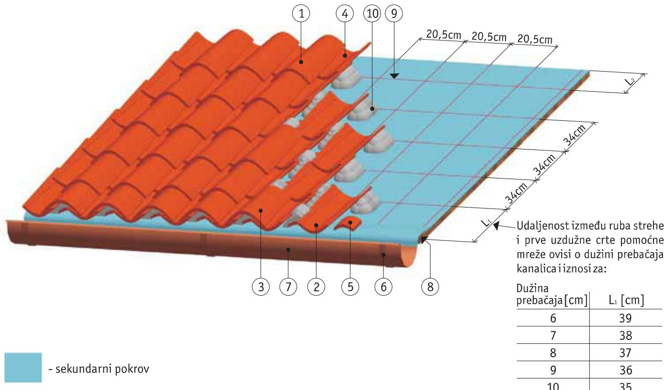
Za sekundarni pokrov preporučuje se uporaba grubo posipanih bitumenskih traka koje omogućavaju kvalitetnije primanje morta na podlogu. Sekundarni pokrov mora biti položen tako da eventualna voda može nesmetano otjecati u oluk.
